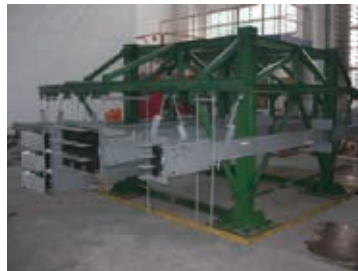
Horizontal seismic test
